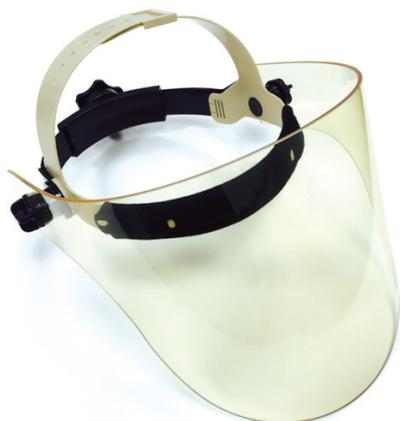
Visière de radioprotection qui élimine les angles morts causés par les lunettes standard et offre une large zone de vision panoramique. La visière de protection a un revêtement anti-rayures et offre une équivalence en plomb de 0,10 mm. Le masque comprend un serre-tête à cliquet qui s'adapte à toutes les tailles et est particulièrement utile pour les personnes qui portent des lunettes et en cas de projection.
