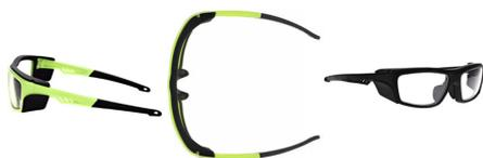
Les verres sont de qualité Schott Glass SF-6 standard de haute qualité et sans distorsion avec une équivalence de plomb de 0,75 mm. Les protections latérales protègent autour de l'orbite de l'œil avec une équivalence de plomb de 0,50 mm.
